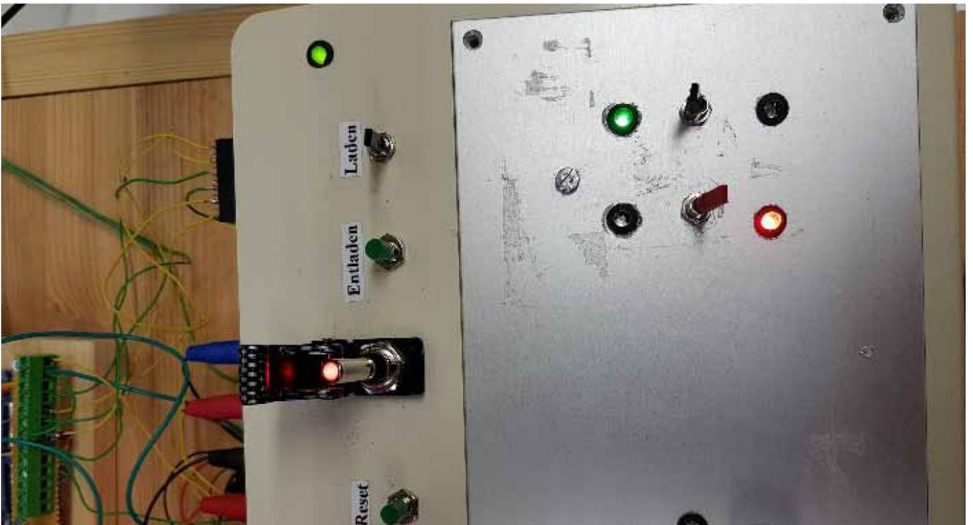
Einheit zur Steuerung des Hochstromimpulses für die Beschleunigungsspulen mittels MOSFET Technik. Zentrale Steuereinheit mit Startknopf (grün), Lade und Entladefunktion der Kondensatoren sowie separate Schaltung der beiden Beschleunigungsspulen.
